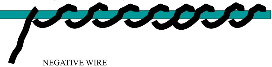
WRAP THE GROUND WIRE AROUND THE ANTENNA WIRE 8 TO 10 TIMES PER FOOT
